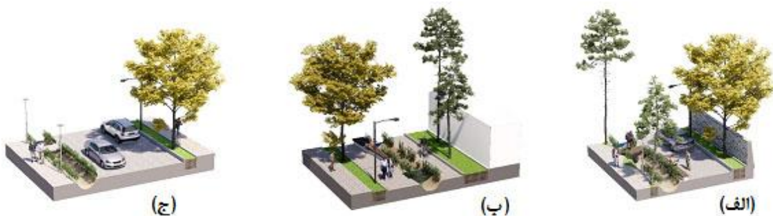
شکل (۱۳): (الف) سواره‌رو درجه دو با اولویت پیاده، (ب) پیاده‌رو با طراحی زهکش طبیعی خطی با پیش‌بینی فضاهایی برای مکث و استراحت، (ج) سواره‌رو درجه یک با طراحی زهکش طبیعی خطی برای هدایت و کنترل آب‌های سطحی (Khoramaraie et al. 2022)
