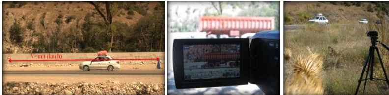
شکل (۴): شمارش تعداد خودروهای عبوری و اندازه‌گیری سرعت خودروها
