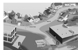
شکل (۷): نمایی از یک سیستم شبکه جمع‌آوری فاضلاب تحت‌خلاء (VSS) (BSI, BS EN 1671, 1997)
